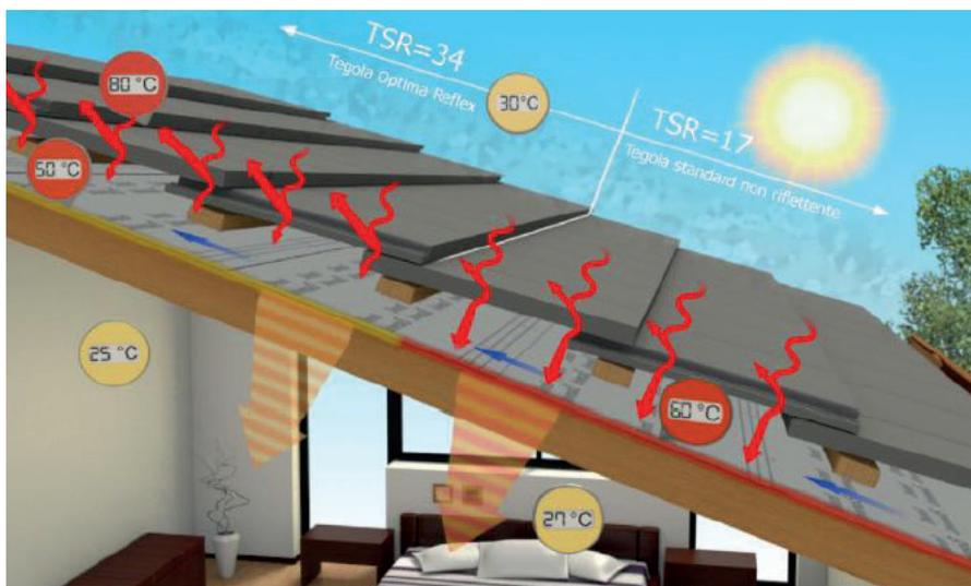
La superficie PROTECTOR REFLEX è in grado di riflettere una frazione della radiazione solare incidente superiore rispetto ad analoghe superfici non riflettenti dello stesso colore, riducendo pertanto l'apporto di calore agli strati sottostanti.
